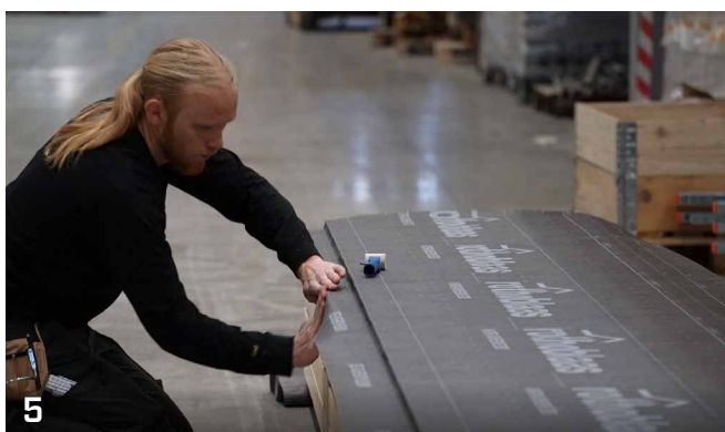
5 O pré-tratamento na fábrica simplifica o processo de colocação, poupando tempo e recursos.
